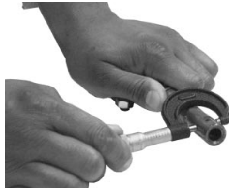
Rocker Arm Shaft OD
