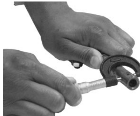
Rocker Arm Shaft OD
