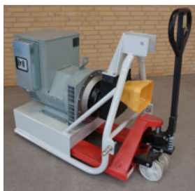
Traktorgeneratoren kan nemt flyttes med en palleløfter.
