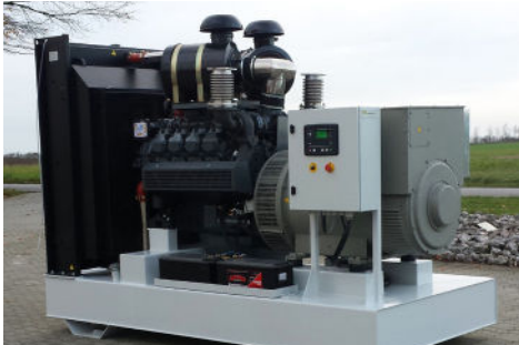
Deutz V8 562 kVA (809 A) anlæg med synkronisering til nødstrøm ved et dambrug.
